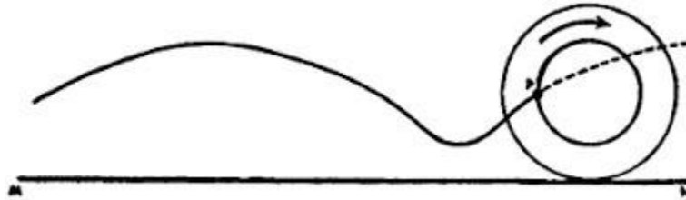
Figura 67. La cicloide acortada está engendrada por el punto P, el cual pertenece al círculo pequeño, a medida que el círculo mayor rueda sobre la recta MN.
