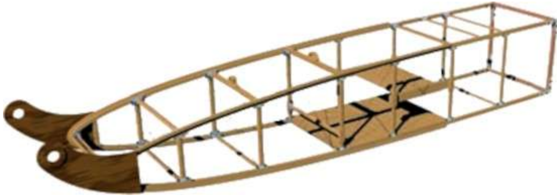
Construcción de la barquilla del fuselaje.
