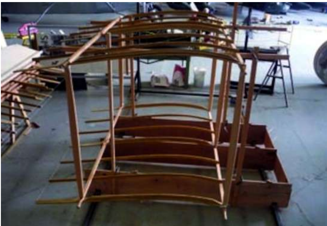
Empenaje biplano del modelo celular en construcción.
