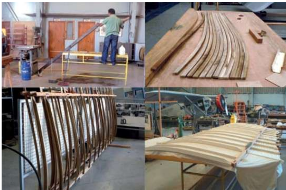
Arriba izquierda: aparato para curvar las costillas; a la derecha, costillas terminadas. Abajo izquierda, alas listas para ser cubiertas; derecha, entelado del ala.
