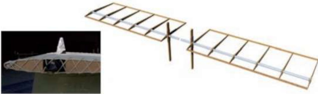
Construcción del elevador
