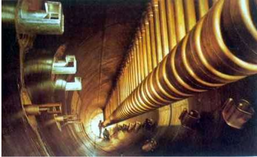
Lámina 29. Acelerador lineal de la Universidad de Berkeley en California. Fue diseñado para poder acelerar partículas pesadas. El diámetro del tubo exterior es de 3 m, lo que puede comprobarse comparándolo con la estatura del operario que aparece de pie al fondo.
